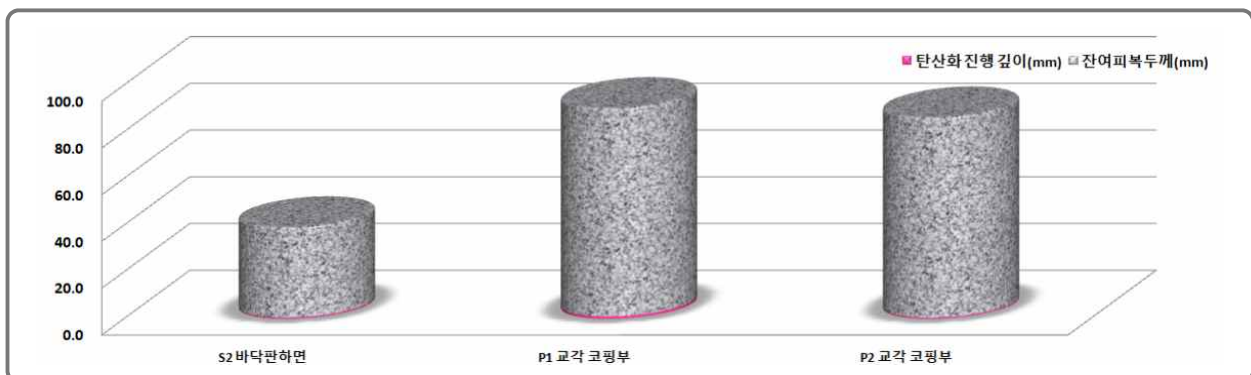
[그림 3.3.5] 탄산화깊이 및 잔여피복두께 측정결과
